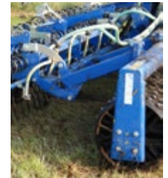
Abb. 6: Gut sichtbar sind die scharfen Striegelzinken und die nachfolgende Pralltellerablage des Sägerätes
